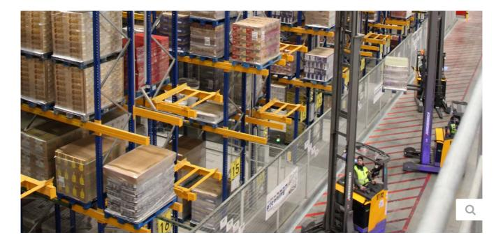
Das Schmalganglager im Multicube Osthessen arbeitetmit vollautomatisierten Regalbediengeräten. Das Ein- und Auslagern erfolgt mit Schubmaststaplern. © Nestlé
